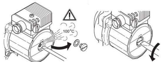
Рисунок 34. Проверка вала насоса
