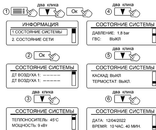
Рисунок 28. Вид вкладки «СОСТОЯНИЕ СИСТЕМЫ»
