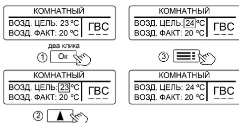
Рисунок 11. Настройка температуры воздуха
