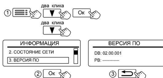
Рисунок 30. Вид вкладки «ВЕРСИЯ ПО»
